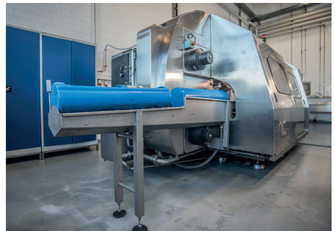
Haltbarmachung bei niedrigen Temperaturen – bei der Hochdrucktechnologie kommen Drücke von rund 6.000 Bar zum Einsatz.
